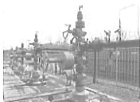
クリスマスツリーとは？ 石油、天然ガスの採掘井に取り付けた地上の設備で、バルブを組み合わせた形からクリスマスツリーと呼ばれています
